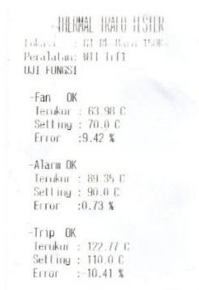
**Gambar 19. Print Out Hasil Pengujian**
