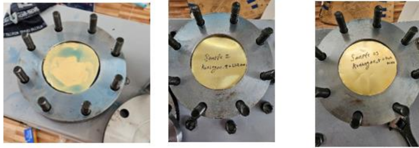
Gambar 11 Spesimen Pengujian Uji Tonjolan Hidrolik Material Metal Foil Kuningan Tebal 0,2mm
