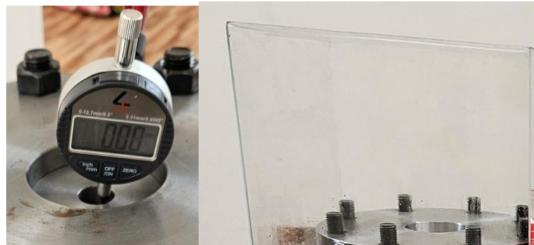
Gambar 6 Dial Indicator dan Cover Protection akrilik
