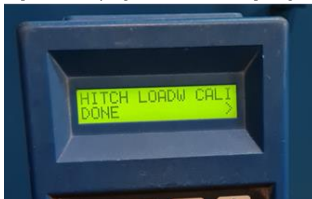
Gambar 8 Kalibrasi Sesor Beban Dinacell (Done)
